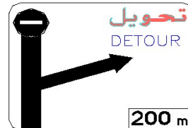
NOTICE THE DIVERSION KD2
